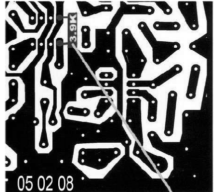
Modification cuivre Ajouter 3.9K entre pin 1 et 8 du MC1350
